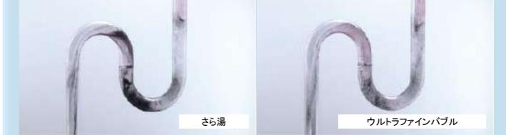
ウルトラファインバブル給湯器なら、さら湯と比べて汚れが
